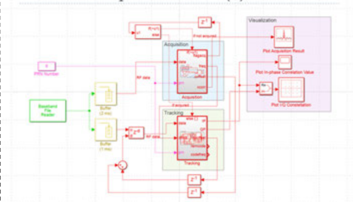
図1 Simulinkで作成した1チャンネルのGNSS信号処理モデル
