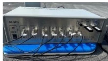
図 2 マルチ受信機システム MA-GNSS
