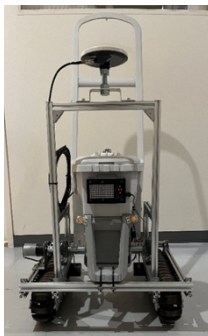
図 1 白線引きクローラ車
