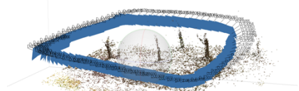
図1 ドローンカメラによるSfM/MVSの例
